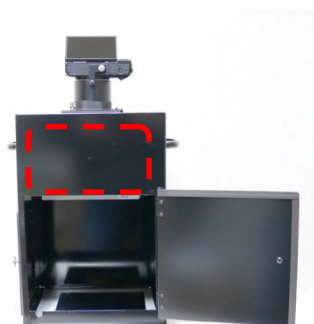
落射撮影 (キャビネット内上部より照射)
