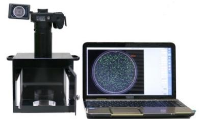
デジタルカメラを使用し、パソコンに取り込んだシャーレ画像を一瞬で自動計測します。
