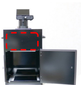
落射撮影 (キャビネット内上部両側より照射)
